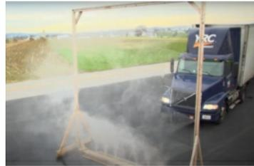
Rociado o nebulizado del interior y exterior, con arco de atomización, con o sin carga animal
