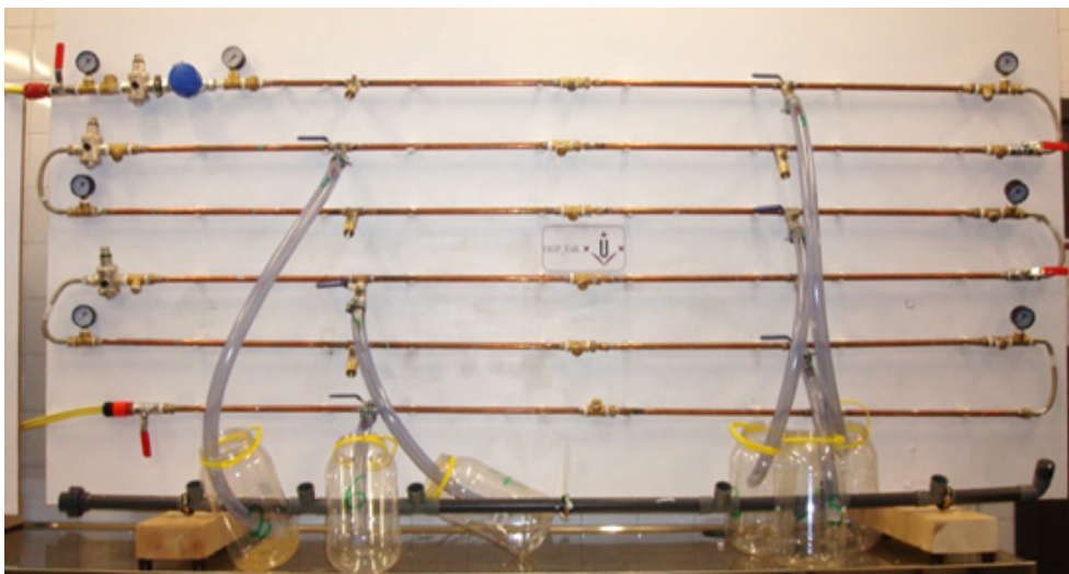
Figura 17. Circuito de agua donde se analizó el efecto de la pérdida de presión.
