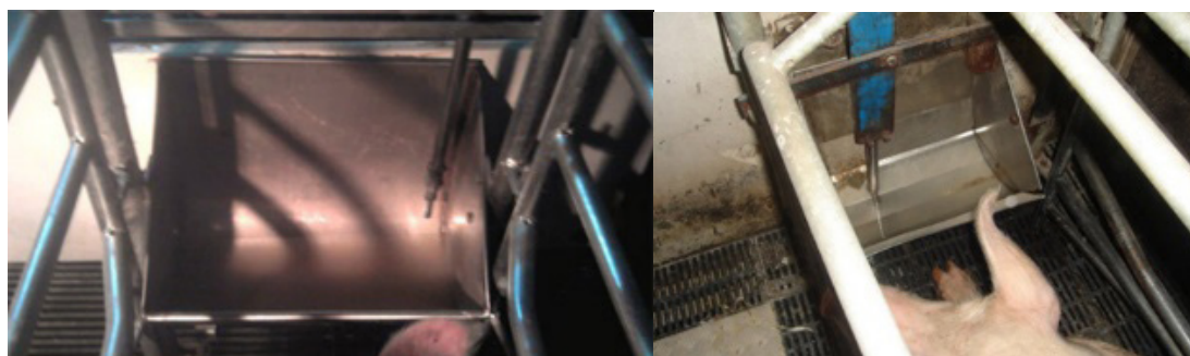
Figura 51. Chupete incorporado en el comedero y comedero con válvula de nivel.
